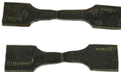
Образцы трубы после разрыва
