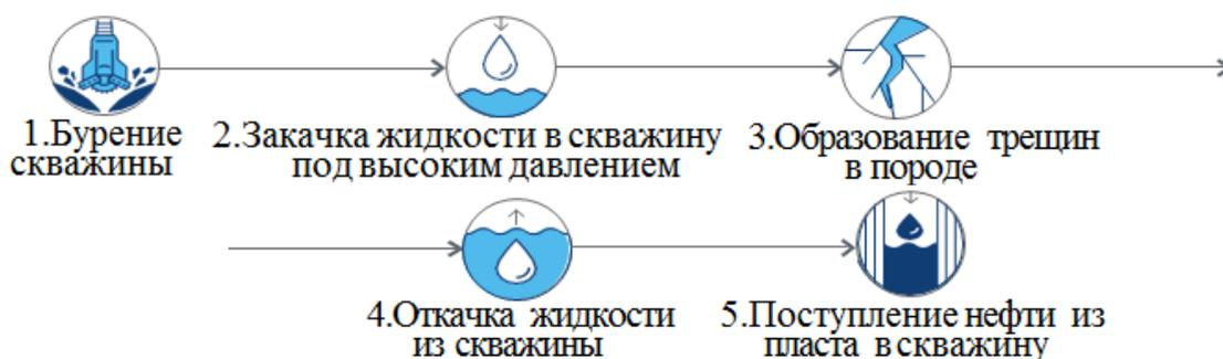
Рис. 2 – Поэтапная схема многостадийного гидроразрыва пласта
