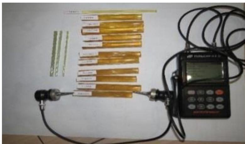
Рис. 2 – Измерение скорости ультразвука в образцах.
