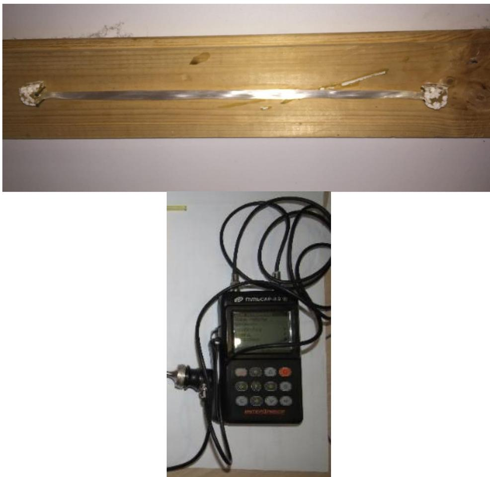
**Рис. 4** – Измерение скорости ультразвука в образцах
