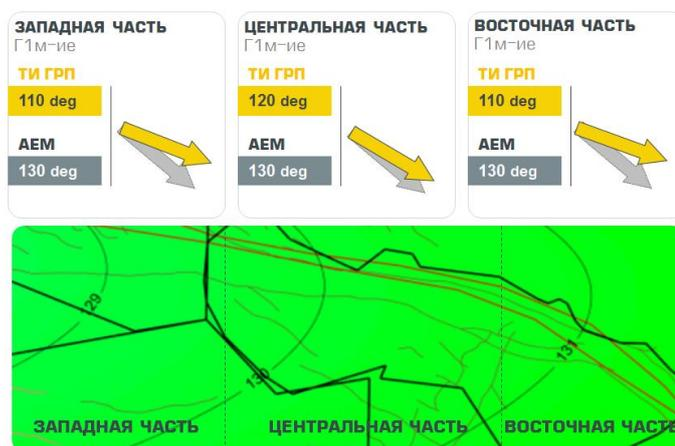
**Рис. 10.** Сравнение результатов предполагаемого направления трещин ГРП и данных по замерам азимутального электрического микроимиджера.
