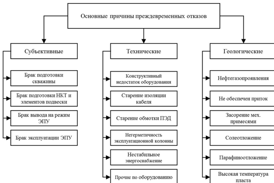
Рис. 3. Основные причины преждевременных отказов в работе ЭПУ и ПЭД
