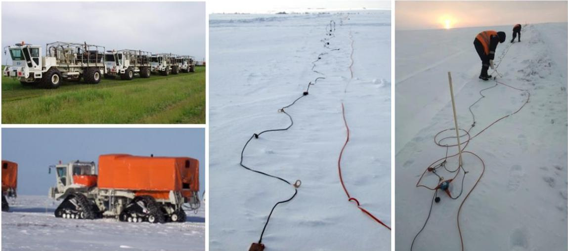
Рис. 1. Сейсмические вибраторы и размотка приёмного оборудования на профиле
