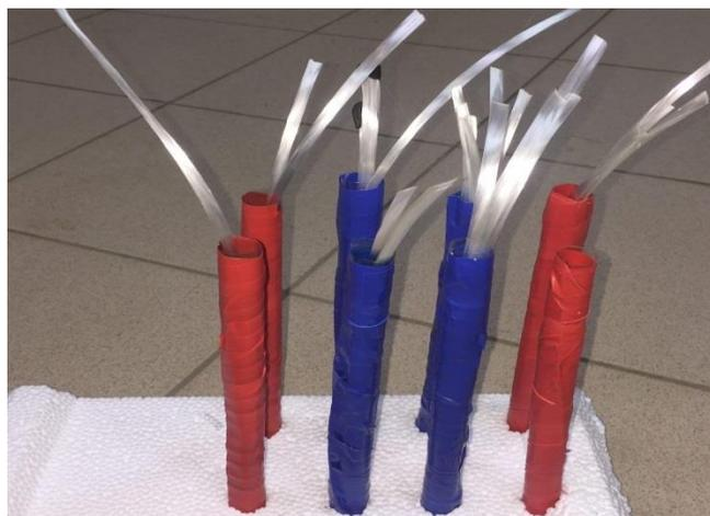
Рис. 1 – Подготовка форм для образцов (опалубки).
