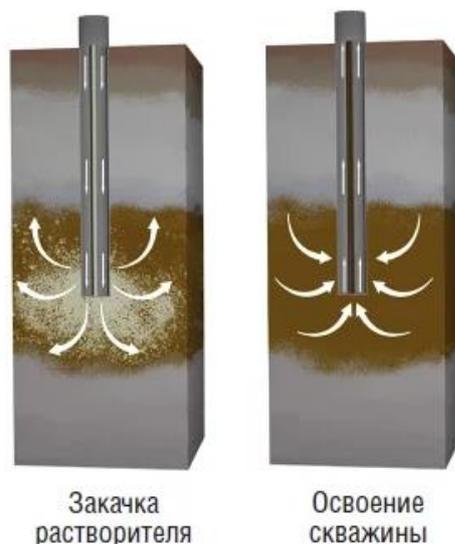
**Рис. 3** – Процесс обработки призабойной зоны пласта вертикальной скважины растворителем на объекте с высоковязкой нефтью [6]
