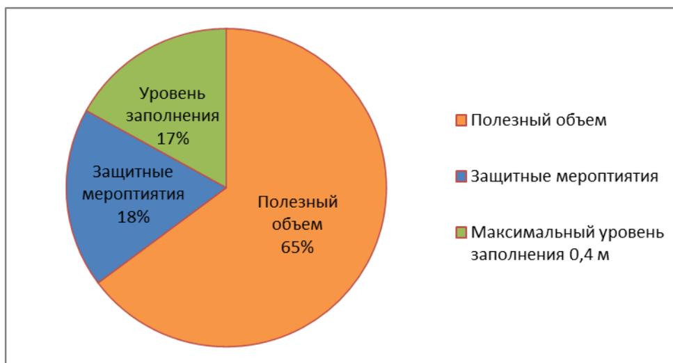
**Рис.2** – Соотношение долей использования секции амбара для твердой фазы
